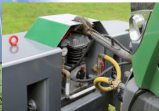
Der hydraulisch angetriebene Zusatz-Druckluftkompressor füllt den 400 l großen Druckspeicher in etwa 10 Minuten auf 15 bar.
